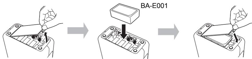
Pour retirer la batterie Li-ion rechargeable, suivez la procédure d'installation dans l'ordre inverse.
